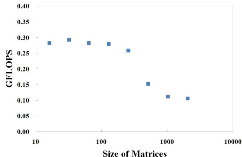
上の表は、一次元表現での計測プログラム(tm)をFujitsu PRIMERGY 単体CPUで実行した結果。右のグラフは、このうちGFLOPSの数値をプロットしたもの。
